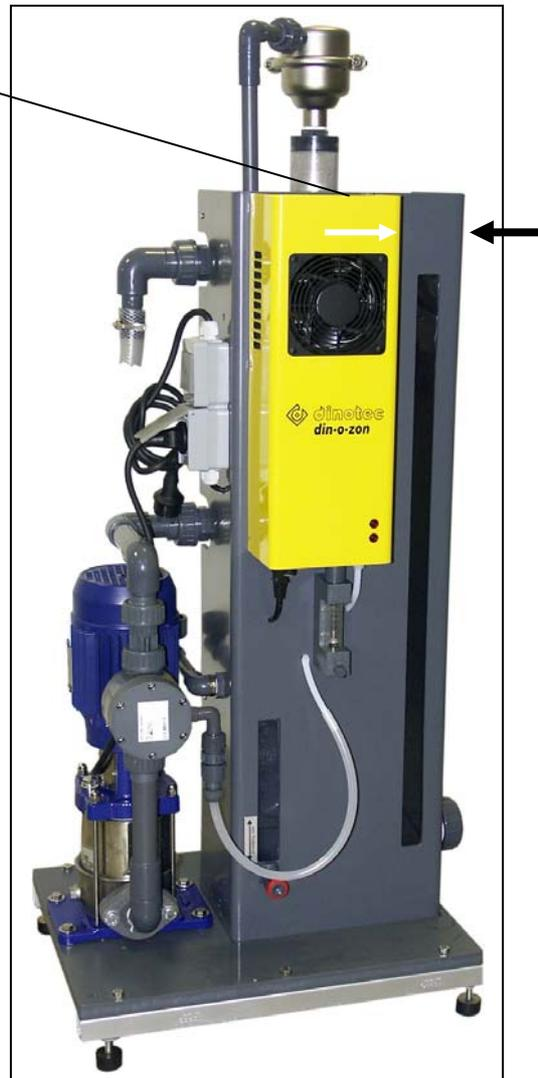
Когда смонтированы все составные узлы установки, проложена трубная обвязка и все предварительные работы перед вводом в эксплуатацию выполнены (раздел 5.0), осторожно открыть кран (циркуляционный насос должен быть включен). В заключение кран подпитки озона медленно открыть. После этого реактор установки *din-o-zon* наполняется водой, воздух выводится через воздушный клапан (поз. 1). Когда в смотровом окне появится поток воды (поз. 21), водяной насос можно включать (поз. 16).
