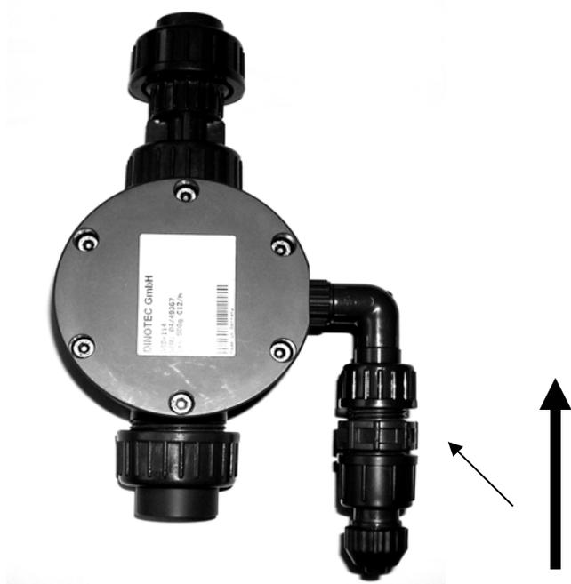
**ВНИМАНИЕ:** РАЗ В ГОД СЛЕДУЕТ ПРОВОДИТЬ ОСМОТР ЭЖЕКТОРА, А ТАКЖЕ ПРОИЗВОДИТЬ ЗАМЕНУ КОМПЛЕКТУЮЩИЕ УСТРОЙСТВА ОБРАТНОГО ХОДА. ФУНКЦИЮ ШАРОВОГО КЛАПАНА ОБРАТНОГО ХОДА ПРОВЕРЯТЬ РЕГУЛЯРНО, ПРИ НЕОБХОДИМОСТИ ПРОИЗВЕСТИ ЗАМЕНУ.
